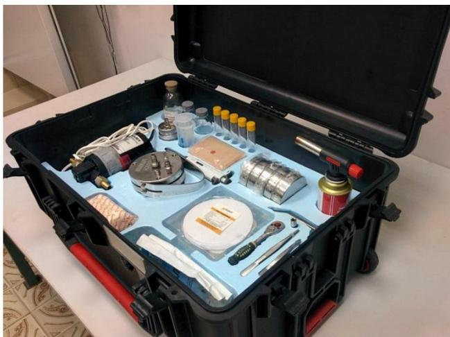
Рисунок 8 – Макет комплекта для пробоподготовки и детекции кишечных бактерий и вирусов в водных объектах
