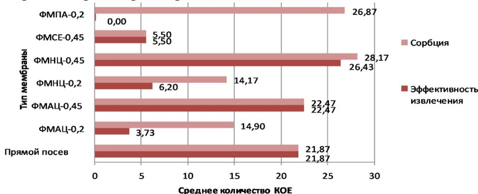
Рисунок 4 – Эффективность сорбции и извлекаемости *E. coli* фильтрующими мембранами при вакуумной фильтрации
