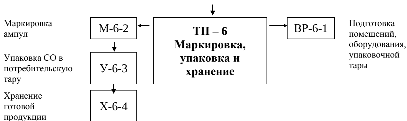
Рисунок 11 – Технологическая схема изготовления и контроля СО специфической активности эритропоэтина по стадиям
