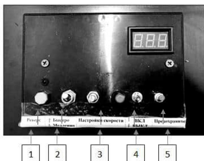
Рисунок 20 — Пульт управления шприцевой помпой, назначение органов управления
