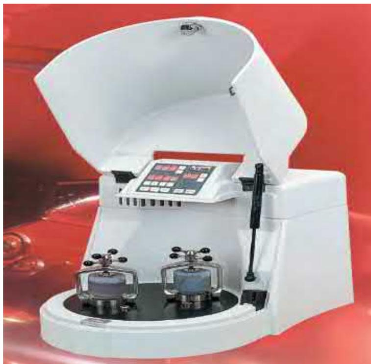
Рисунок 17 – Шаровая планетарная мельница Fritsch P-7 (Германия)
