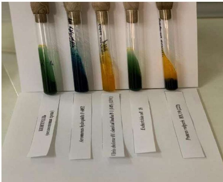
Рисунок 7 - Цвет АЖС-агара при посеве в него тест-штаммов микроорганизмов - целевых аналитов
