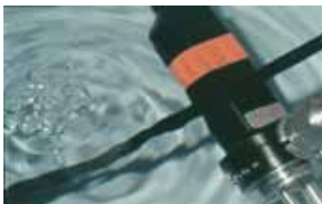
Рис. 22. Признаки нарушения герметичности эндоскопа
