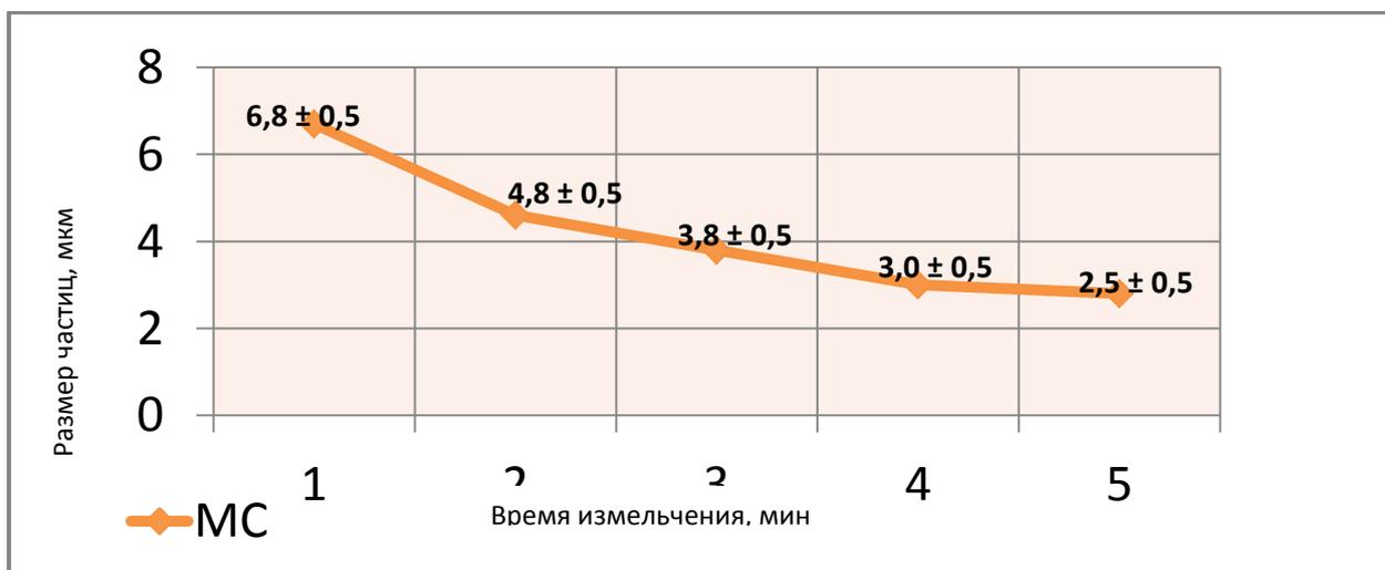
Рисунок 2 – Распределение МС по размерам, полученным при измельчении МС в течение 1-5 мин
